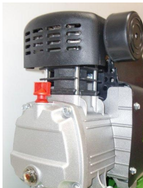
Ölverschluss entfernen und Entlüftungsstopfen eindrücken
