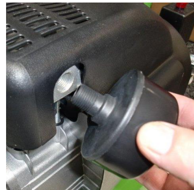
Verschlusskappe entfernen und Luftfilter handfest einschrauben
